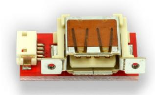
USB - Adapter für die Gehäusemontage mit geringer Aufbauhöhe
